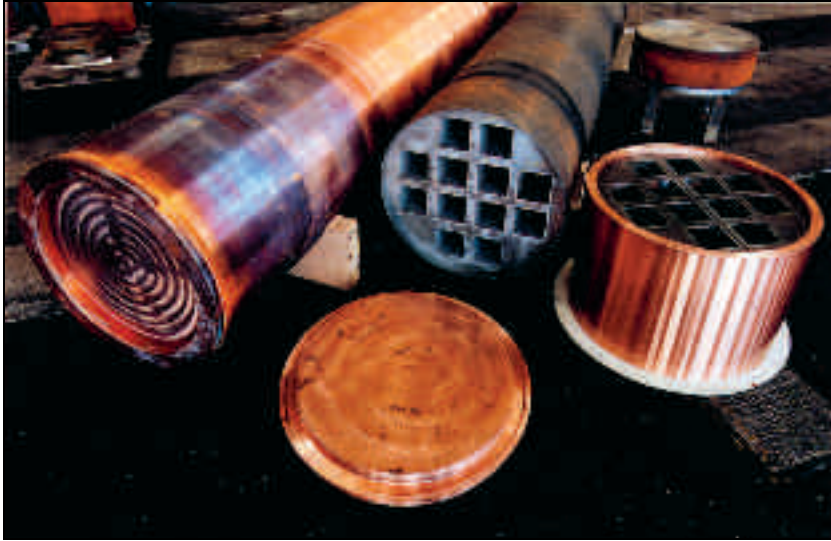
Figur 4.2 Exempel på tillverkade kapselkomponenter: kopparrör, segjärn, insats och kopparlock
